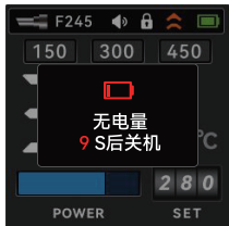
④ 低电量: 当设备电量过低时, 屏幕弹出提示框显示“低电量 9S 后关机”, 提醒用户设备电量不足, 9 秒后将自动关机。
