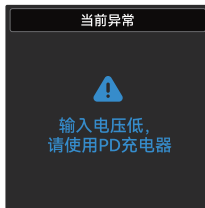
⑤ 低电压: 当输入电压过低时, 屏幕会弹出提示框显示“输入电压低, 请使用PD充电器。”, 提醒用户当前输入电压不足, 建议使用PD充电器进行充电。
